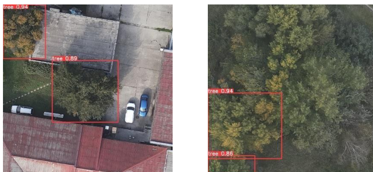
Obrázok 4. Segmentovanie stromov v ortofotomozaike pomocou nástroja YOLOv5. Obrázok ilustruje problém detekcie jednotlivých stromov v prípade hustej vegetácie (súvislého porastu).
