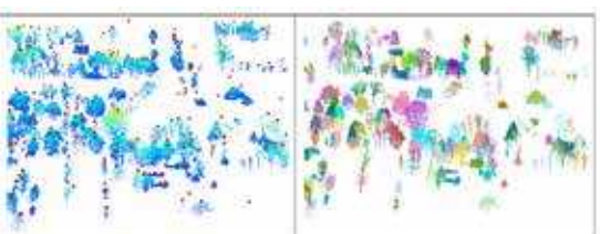
Mapovanie polohy a výšky stromov v PointCloud dátach získaných pomocou LiDAR technológie
